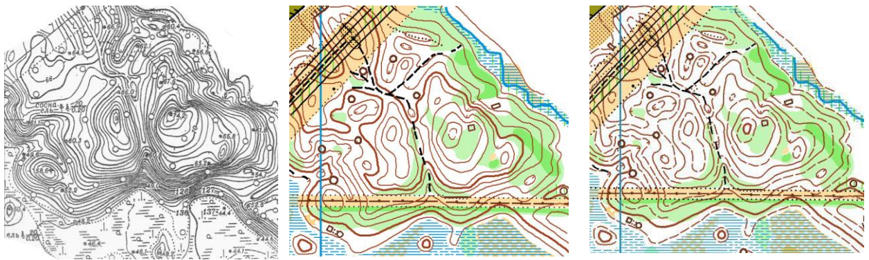
А. Сечение рельефа 1 м В. Сечение рельефа 2,5 м С. Сечение рельефа 5 м Рис. 6.
